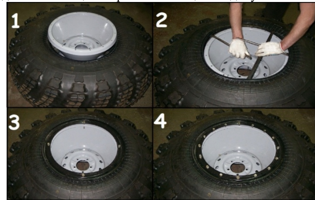
Рис. 10.4 Порядок монтажа шины ТРЭКОЛ
