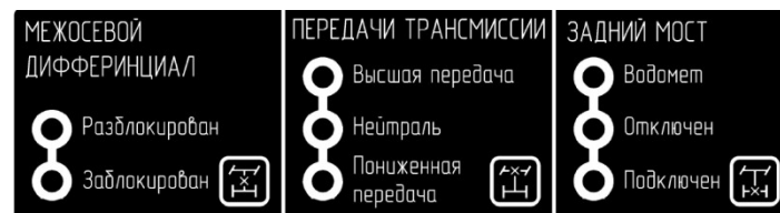
Рис. 6.6 Схема управления раздаточной коробкой и коробкой привода заднего ведущего моста с приводом водомётного движителя
