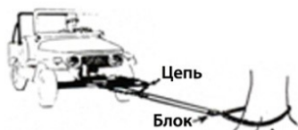
Рис. 20.7 В основном то же, что на рис. 20.6. Цепь с распределителем помогает равномерно распределить нагрузку по составным частям автомобиля
