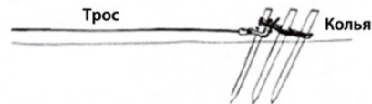
Рис. 20.11 Показывает пример правильного использования колец. Это очень эффективный якорь, если почва позволяет им пользоваться. В землю их следует забивать под углом
