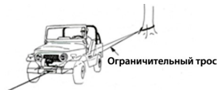
Рис. 20.9 Пример того, как правильно ограничивать автомобиль при транспортировке тяжелых грузов, когда колесных блоков недостаточно. Ограничительный трос или цепь прикрепляется к якорю как можно ниже, проходит под автомобилем и надежно крепится за прочие части установочного комплекта лебедки. Способ крепления к задней раме или балке моста имеет определенный риск. Мощности лебедки достаточно, чтобы сломать или погнуть раму или балку моста
